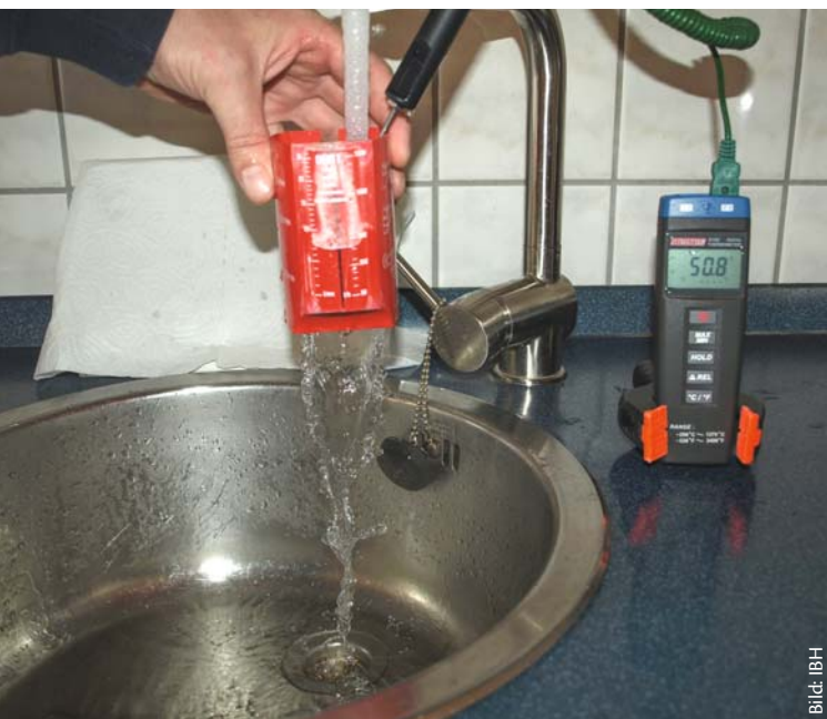
Der Durchfluss-Messbecher zeigt rund 7 l/min an. Die Temperatur liegt bei 50,8 °C
