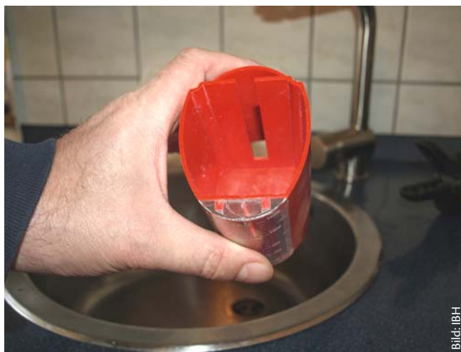
Der Durchfluss-Messbecher ist gewissermaßen definiert undicht
