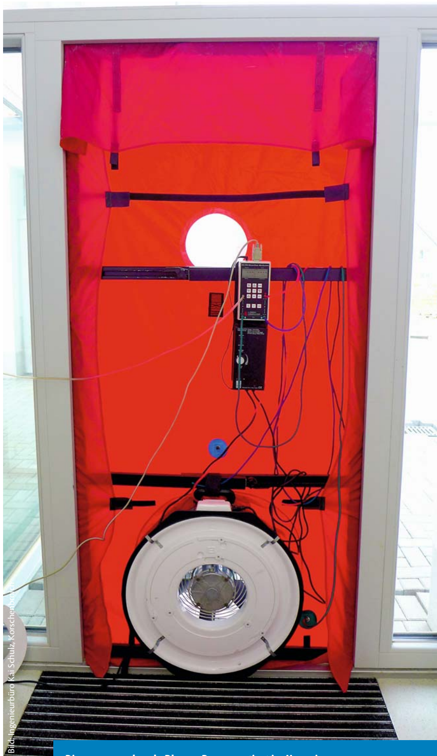
Die namensgebende Blower-Door montiert im Hauseingang
